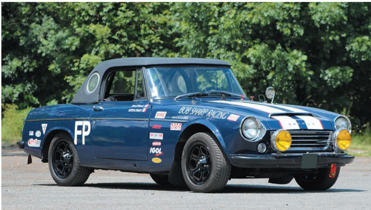
La Datsun Sports ou Fairlady est lancée en 1963. Le petit roadster connaît sa principale évolution avec l'avènement du type SPL 311. Equipé d'un nouveau moteur de 1600 cm<sup>3</sup> à 5 paliers et à arbre à cames en tête développant 95 ch, il promet plus de 160km/h en vitesse de pointe.
