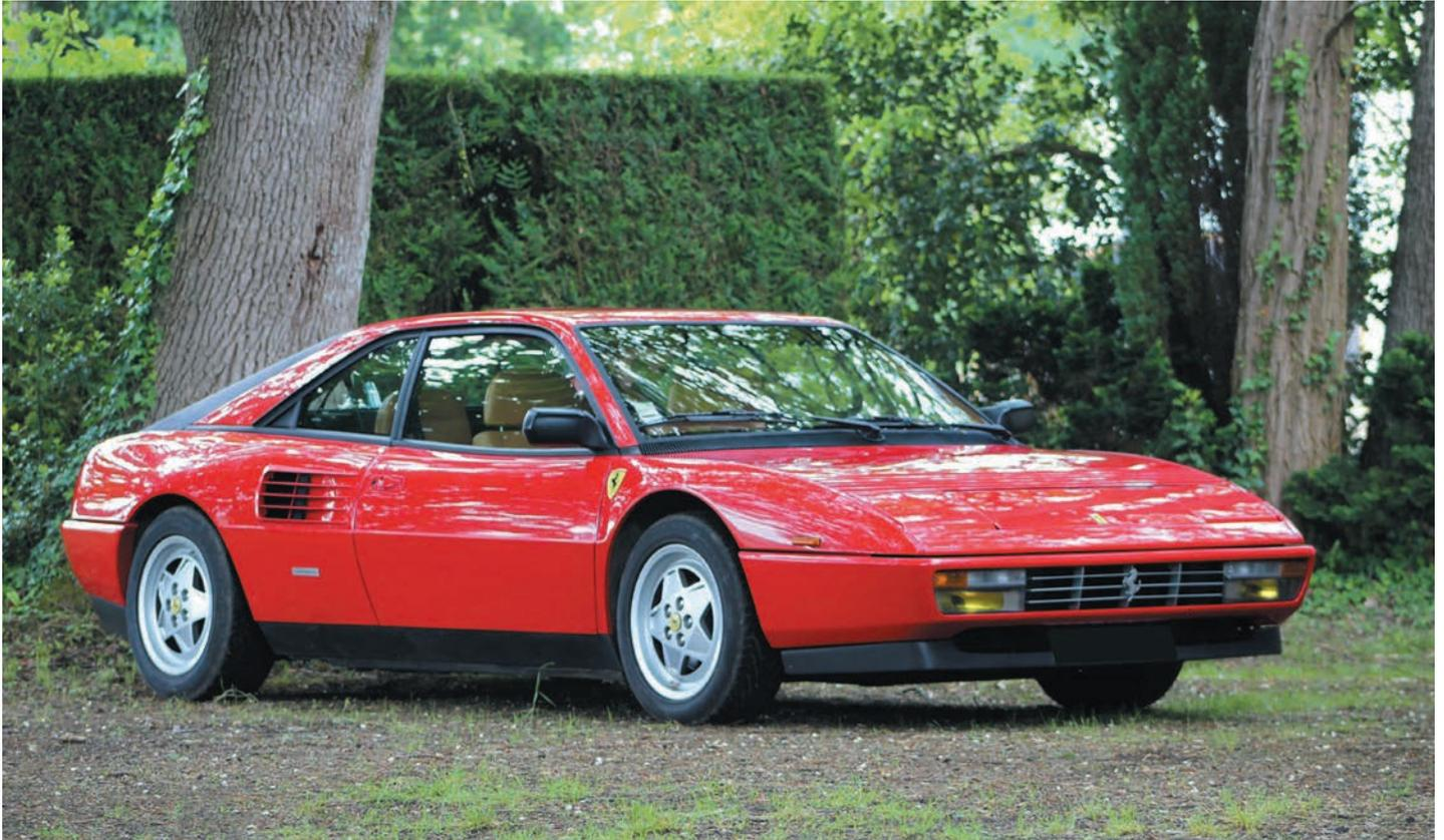
Ultime évolution de la lignée des Mondial, la T se caractérise par sa mécanique de 3.4 portée à 300 cv et dorénavant placée en position longitudinale, améliorant ainsi la répartition des masses et son comportement dynamique.
