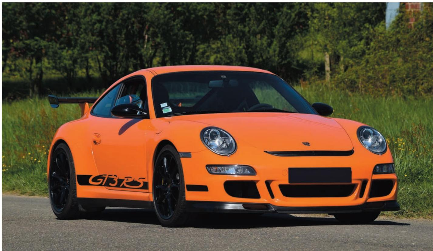
Véritable voiture de piste immatriculée, la 997 GT3 RS était, dans sa première version, dotée du moteur 3.6L de 415 cv. Elle se distinguait de la version GT3 par une voie élargie, un imposant aileron en carbone réglable et une finition plus radicale, perdant au passage 20 kg. Sa production n'excédera pas les 1909 exemplaires.
