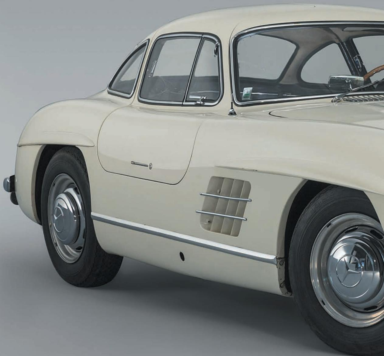
Châssis tubulaire, moteur six-cylindres à injection directe, carter sec, freins ailetés Alfin, roues indépendantes, carrosserie profilée, la Mercedes 300 SL est née de la course automobile. Les meilleurs ingénieurs de Mercedes se sont penchés sur son berceau et, merveilleuse trouvaille, les ailes « papillon » qui vont lui donner
