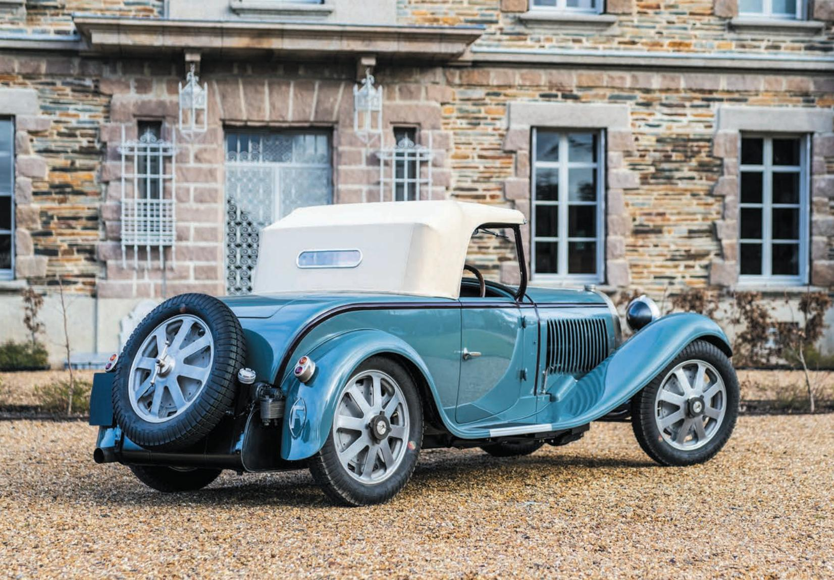
Pour cette nouvelle course, le stomatologue demanda à un ouvrier tôlier employé au garage Continental, Monsieur Molla, de modifier la caisse de sa Bugatti Type 55 roadster, en fabricant des éléments en aluminium adaptés sur la structure bois du roadster Vanvooren. La partie centrale de la caisse en tôle fut conservée. Les portes furent échançrées et des ailes sport remplacèrent les longues ailes d'origine. La course se déroulait en trois étapes en boucles :
