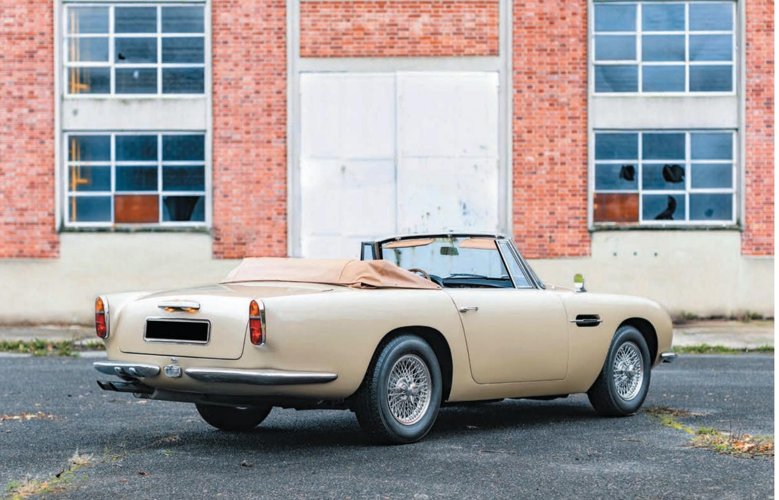
>>>DB5, plus courte que celle de la DB6 qui changeait complètement de type de fabrication par rapport à ses devancières; alors que la Volante reste fidèle à la méthode Touring « Superleggera » constituée d'une armature de fins tubes d'acier recevant les panneaux de carrosserie.
