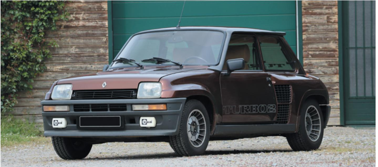
La Renault 5 Turbo 2 était une évolution de la Renault 5 Turbo qui, avec son moteur central et ses 160 ch soufflés par le turbocompresseur, était un véritable missile sur route. Dévoilée en 1982, la Turbo 2 reprenait la même mécanique mais, pour permettre un prix plus abordable, elle adoptait l'intérieur de la Renault 5 Alpine Turbo et recevait des portes et un toit en acier au lieu de l'aluminium. Sur le plan comportement, elle ne perdait rien des performances de sa devancière.
