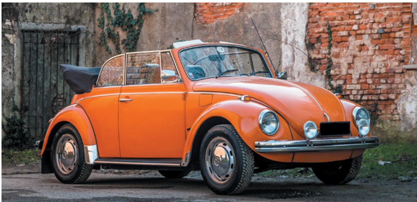
La Coccinelle cabriolet, dans sa version 1302 S, est un choix intéressant car elle dispose notamment d'un train avant modernisé, d'une boîte de vitesses à cardans, de freins à disques à l'avant et d'un moteur 1.6L plus coupleux et puissant que les versions 1.3L, tandis qu'elle conserve le pare-brise plat qui rappelle les premières générations.
