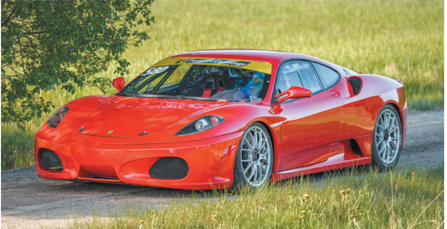
La version Challenge de la Ferrari F430 était une « compétition-client » qui reprenait le moteur standard de la 430 (V8 de 4,3 Litres et 490 ch) mais dont le châssis, les trains roulants et l'aménagement avaient été radicalement revus pour une utilisation circuit. Plus rigide, plus légère et avec une suspension et des freins modifiés, la F430 Challenge était à son époque une des meilleures machines de sa catégorie, en plus de porter un nom prestigieux.
