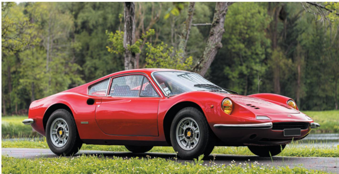
Dès les années 60, Ferrari souhaitait s'ouvrir à des modèles de moindre cylindrée et de plus grande diffusion. Après plusieurs années d'études, Pininfarina proposa en 1967 la Dino 206 GT dotée d'un nouveau châssis tubulaire et d'un V6 longitudinal en aluminium en position centrale.
