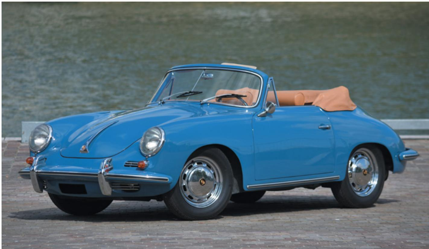
Si la 356 est le premier modèle produit par Porsche, sa version SC (Super C) en est l'ultime aboutissement, la plus performante en dehors des Carrera. En effet, sa puissance culmine à 95cv, l'embrayage est renforcé, des freins à disques sont installés et complètent les nombreuses améliorations apportées tout au long de la carrière de ce modèle emblématique.
