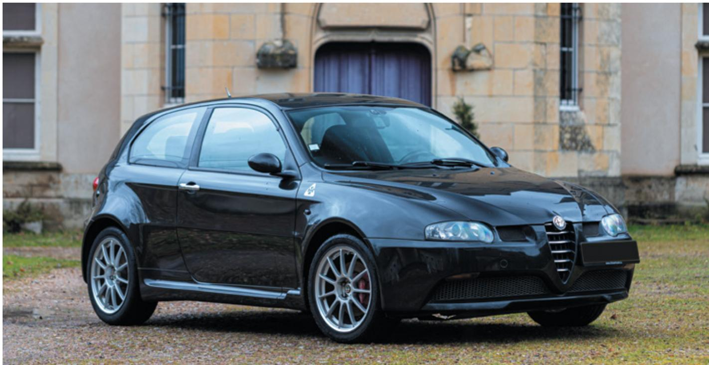
En installant le V6 de 3,2 litres et 250 ch sous le capot de la compacte I47, Alfa Romeo a créé une véritable bombe capable de frôler 250 km/h, ce qui répondait à son appellation « GTA ». Malgré les limites imposées par la traction avant, son empattement court la rendait particulièrement alerte et réactive.
