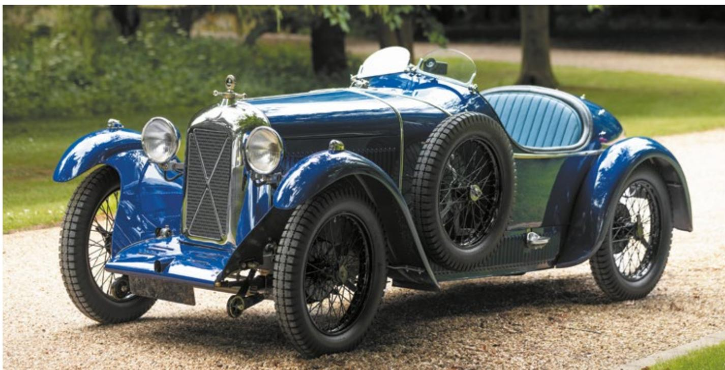
Fruit de près d'une décennie d'améliorations de ses cyclecars et voiturettes, le type GS8 fut mis en production par Salmson en 1928. Il rassemblait le meilleur du savoir-faire de la marque, équipé d'une brillante mécanique 1100 cm<sup>3</sup> à double arbre à cames en tête, tout en utilisant le châssis surbaissé de la rare version Grand Prix, plus large et plus bas que les modèles précédents.
