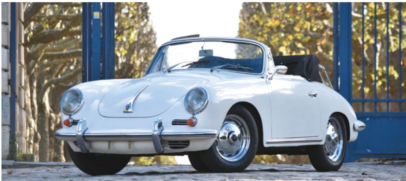
Version recherchée, la 356 B 1600 Super combine les joies du cabriolet avec une version évoluée du 4-cylindres à plat de 1600 cm<sup>3</sup> qui développe 75cv et permet d'atteindre 175 km/h en pointe.
