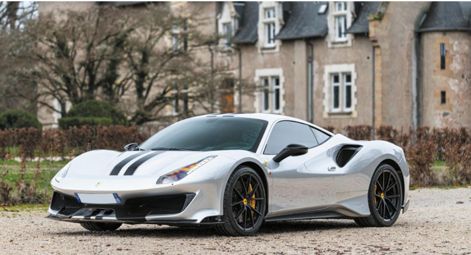
La 488 Pista fait sensation grâce à ses évolutions remarquables : le moteur adopte des pistons renforcés, des bielles en titane, de nouveaux arbres à cames et des collecteurs d'échappement en Inconel issus de la Challenge. Ces améliorations portent la puissance du V8 à 720 ch à 8 000 tr/mn ! Les passages de rapports sont expédiés en 30 millisecondes. L'emploi du carbone et le travail sur l'aérodynamisme permet à l'ensemble de gagner 90 kg et 20% d'appui.
