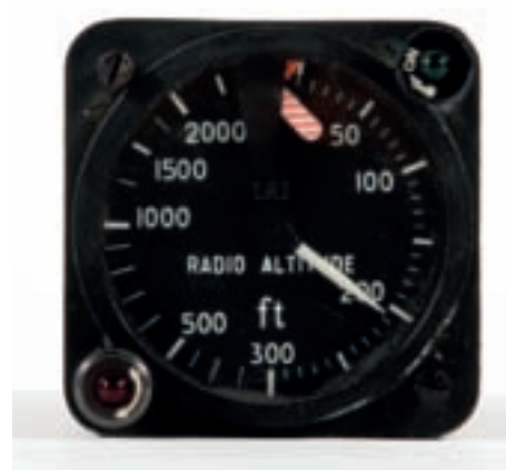
•341• MIRAGE III Radioaltimètre Constructeur : Brion Leroux Références : AHV3-091 type 3536-11 n°189 8,5 x 8,5 x 14 cm 500/600 €
