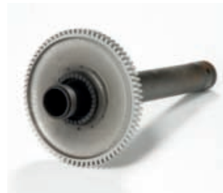
•372• MIRAGE III Axe de turbine en alliage spécifique Longueur : 110 cm. Diamètre : 80cm 100/150 €
