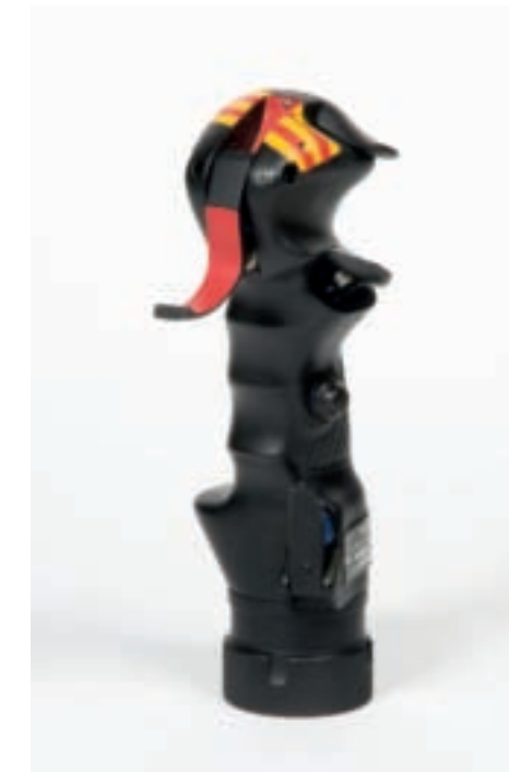
• 412 • MIRAGE III Poignée de pilote révision générale le 31/05/90, en aluminium, faisceaux électriques, interrupteur en bakélite. Constructeur : SMM Référence : type 112A10 n°24610361 20 cm 3000/4000 €
