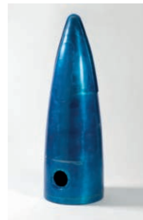
•361• MIRAGE III Cône avant de réservoir en alliage spécifique, recouvert d'un vernis protecteur bleu irisé. 1,86 m 1000/1200 €
