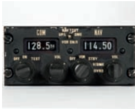
• 408 • MIRAGE III Radio pour le système communication et navigation Constructeur : Electronique Aérospatiale Référence : BCN3671D n°3905, date : 06/84 6,5 x 14 x 12 cm 500/600 €
