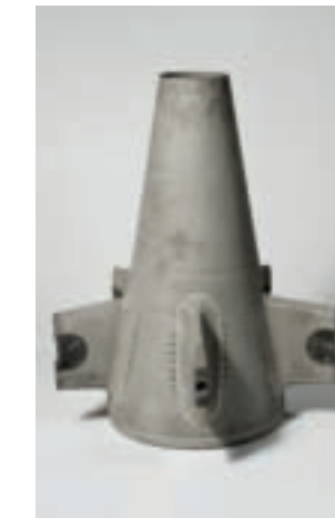
• 419 • MIRAGE III Cône de la sortie de la turbine de réacteur ATAR 9 en alliage en métaux résistant à haute température. Constructeur : SNECMA 91 cm 800/1000 €
