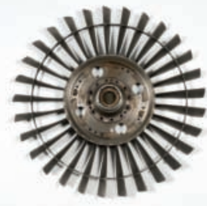
•357• MIRAGE III Disque de turbine à aubes droites premier étage du compresseur. Diamètre : 80 cm 600/800 €
