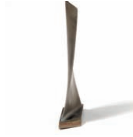
•373• MIRAGE III Aube de turbine en alliage spécifique résistant à la chaleur du compresseur 15,5 x 6,5 cm 150/200 €
