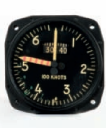
•342• VAUTOUR Indicateur de vitesse Constructeur : Kollsman Références : PITOT Statique L7 8 x 8 x 12,5 cm 500/600 €
