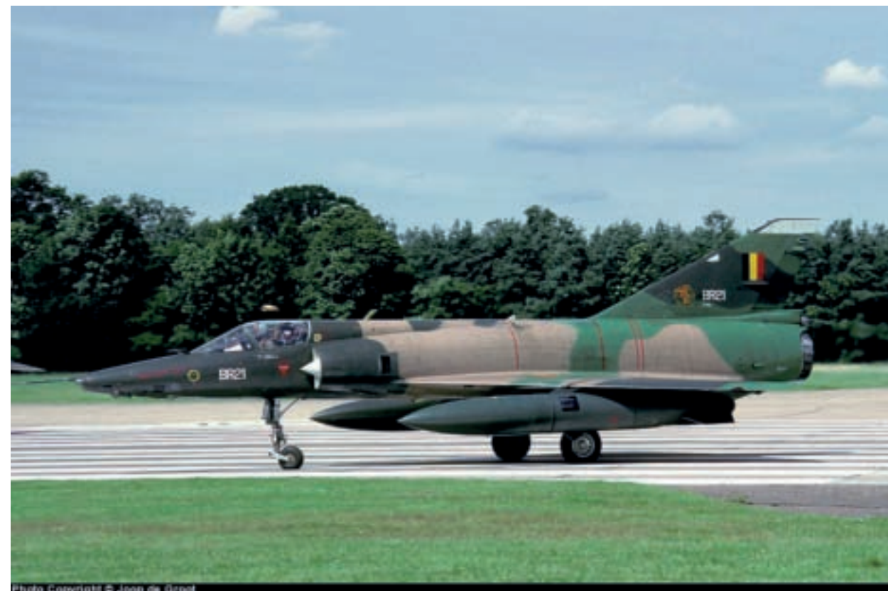
• 411 • MIRAGE 5 BR-21 Caractéristiques Techniques Envergure : 8,22 m Longueur : 13,85 m Hauteur : 4,50 m Moteur : 1 SNECMA ATAR avec postcombustion. Poussée : 6.144 Kg Plafond : 18.000 m Vitesse : Mach 2,3 Désarmé.
