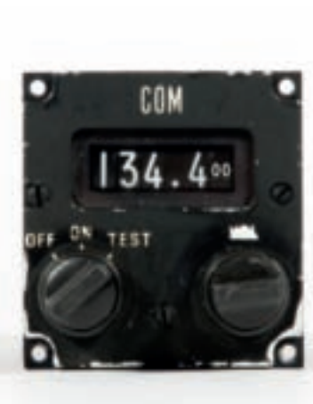
•350• MIRAGE III Sélecteur de fréquence radio Constructeur : Electronique Aéronautique Référence : BC515 n°286, date 8/78 6 x 6,5 x 11 cm 100/150 €
