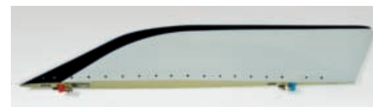
•366• MIRAGE III Carénage d'antenne initialement positionnée sur la partie supérieure de la dérive en matériaux composites résistant aux hautes températures. 17 x 82 cm 800/1000 €
