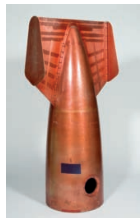
•362• MIRAGE III Cône arrière de réservoir largable de 1 300 litres en alliage spécifique, recouvert d'un vernis protecteur orange irisé 1,92 m Ce réservoir augmentait la durée de vol de 30 minutes lors des missions d'accompagnement
