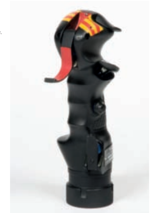
•402• MIRAGE III Poignée de pilote révision générale le 31/05/90, en aluminium, faisceaux électriques, interrupteur en bakélite. Constructeur : SMM Référence : type 112A10 n°24610361 20 cm 3000/4000 €
