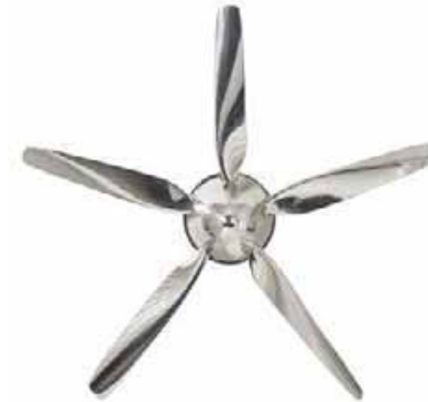
• 359 • AVIA Hélice à cinq pales En alliage aéronautique spécifique, poli miroir, avec son spinner, pour avion militaire Orlik Diam. : 220 cm. (86 1/2 in.) A five-pale propeller, Avia for Orlik 4 000 – 6 000 €
