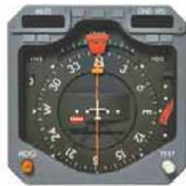
• 289 • CONCORDE Indicateur de situation horizontale HSI (Heading Situation Indicator) A volé. N° de série: 5066 Haut.: 13 cm. (5 in.), Larg.: 12,5 cm. (5 in.), Prof.: 23,5 cm. (9 ¼ in.) Provenance: Musée Air France A flown heading situation indicator 7 000 – 10 000 €
